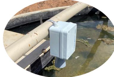
Sensor ultrasónico para monitoreo del nivel de agua en tanques y abrevaderos.
