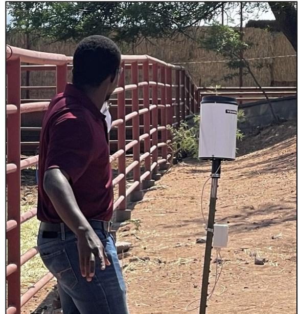
Pluviómetro de radio frecuencia instalado en cercanía de un corral de encierre.
